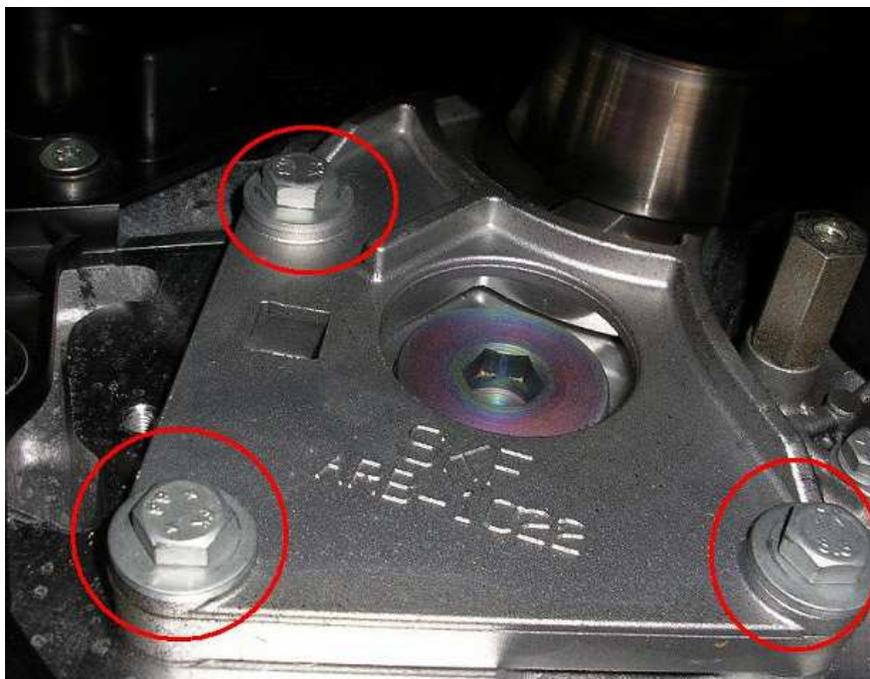
Déposer alors l'ensemble de la platine du galet tendeur.
