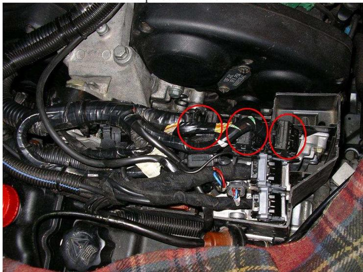
Sortir le calculateur du logement plastique en tirant simplement vers le haut. Le déposer.
