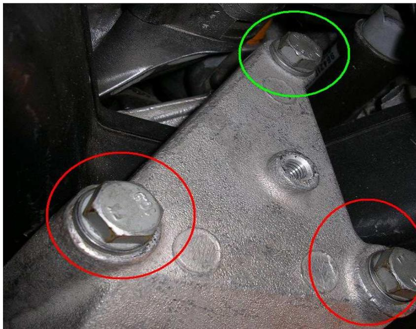
Les deux boulons entourés en rouge sont des boulons de 16 (M10x115mm). Celui entouré en vert est un boulon de 16 (M10x65mm).
