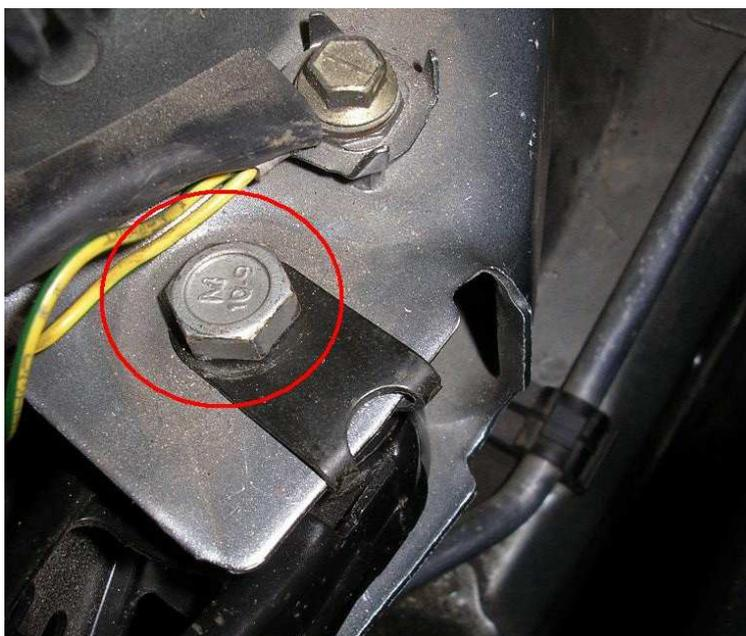
Sur la platine aluminium, la biellette est fixée par un boulon qui traverse de part en part. L'écrou carré prisonnier permet de dévisser le boulon avec une douille de 16 :
