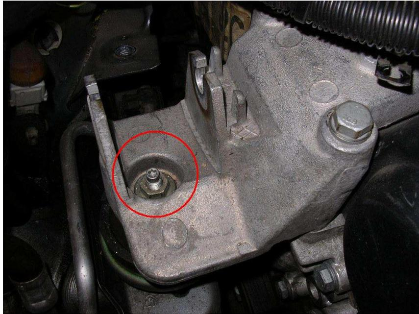
Dévisser les 3 boulons M8 du support aluminium supérieur moteur droit avec une douille de 16 :
